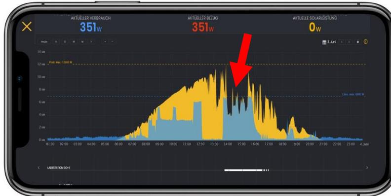
**Bei kurzzeitiger Reduktion (z.B. durch Wolken) wird der Ladestrom entsprechend reduziert**
