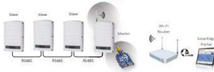
Szenario B: Anbindung mehrerer Wechselrichter via RS485 Bus (bis zu 32 SolarEdge Geräte)
